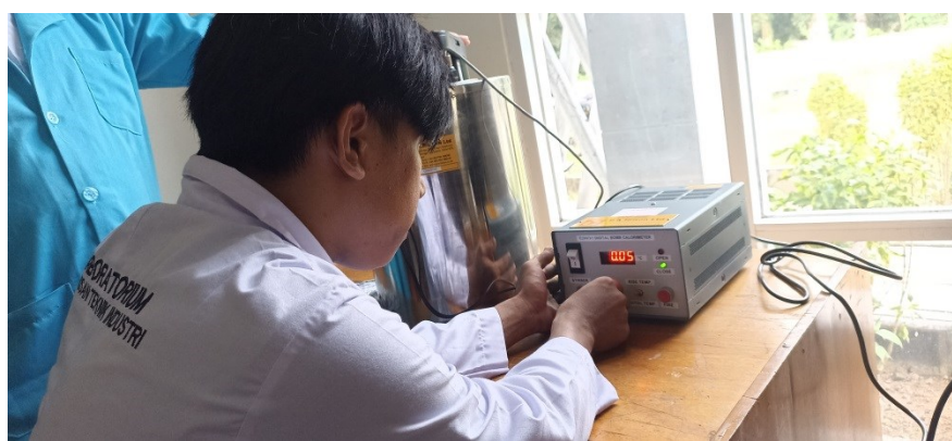
Gambar 2 Pengujian Nilai Kalor Menggunakan Alat Bomb Calorimeter
