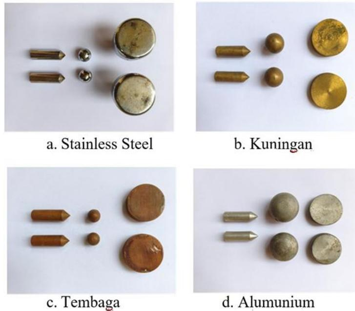
**Gambar 1.** Elektroda pengujian
