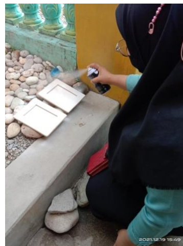
Gambar. 3. Penyemprotan Pilox pada rangka bingkai foto
